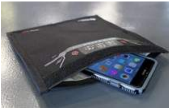
ภาพแสดง ตัวอย่างวัตถุพยานทางดิจิทัล Smart Phone บรรจุในถุงกันคลื่นแม่เหล็กไฟฟ้า (Faraday Bag)
